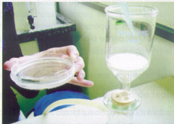
Fig. 10. Retirada do excesso de glicerol da suspensão de JI, sobre papel filtro em funil de Buchner, com vácuo.
