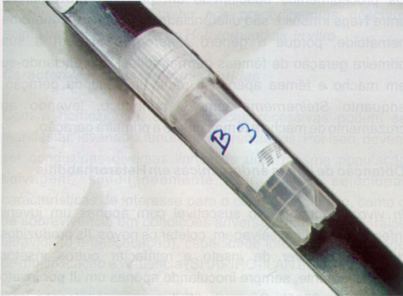
Fig. 11. Criotubo sustentado em perfil metálico para acondicionamento em botijão com nitrogênio líquido.
