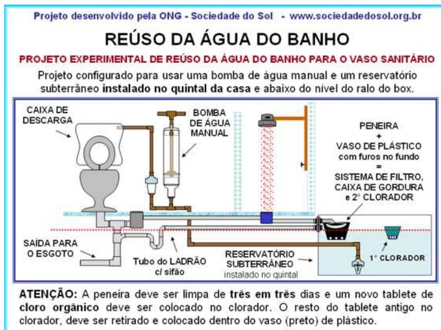
Figura 8. Esquema de técnica para reúso de água do banho.
