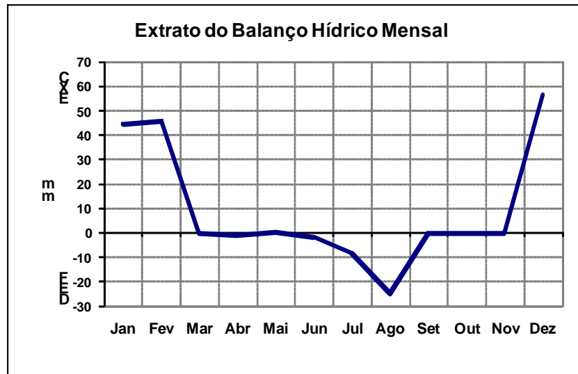
Figura 2. Representação do balanço hídrico, estratificando os períodos de retirada e reposição de água, para o município de Corguinho (MS).
