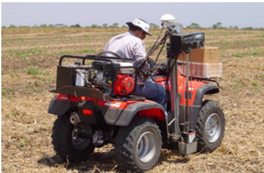
Figura 2. Quadriciclo equipado com amostrador de solo (Foto: Bunge Fertilizantes).
