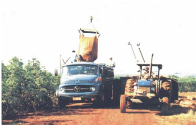
Fig. 6. Guincho para carregamento dos sacolões no caminhão. Fonte: Takahashi & Gonçalves (2001).
