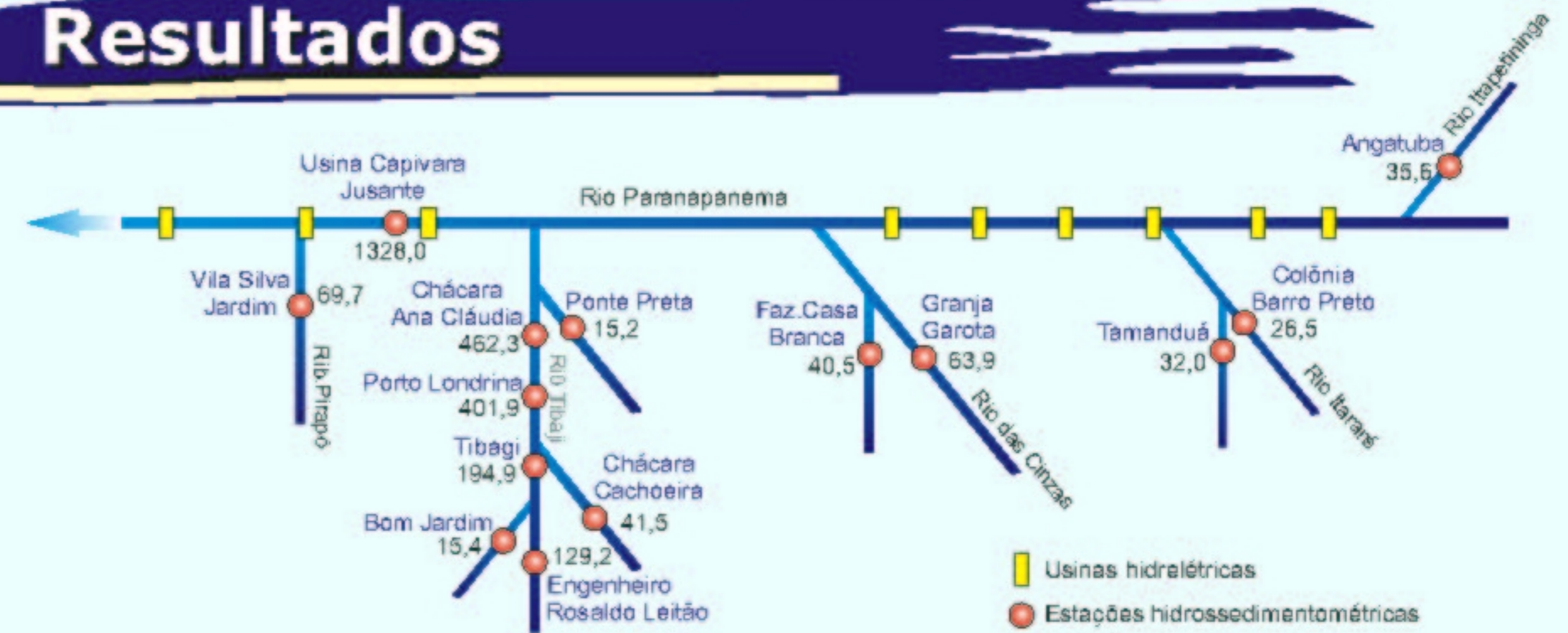
Figura 3. Vazões médias (m 3 /s) nas estações hidrossedimentométricas da Bacia do Rio Paranapanema, de 1981 a 2002.
