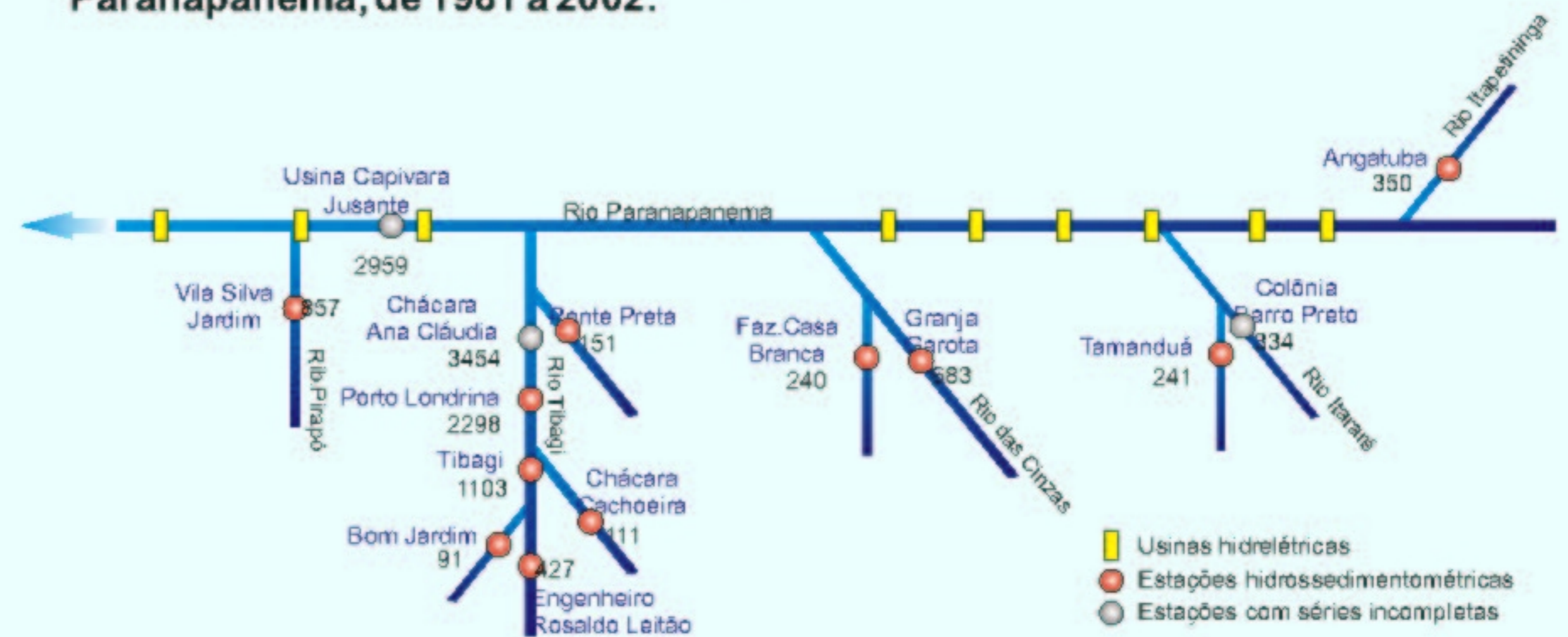
Figura 4. Descarga sólida em suspensão média (t/dia) nas estações hidrossedimentométricas da Bacia do Rio Paranapanema, de 1981 a 2002.
