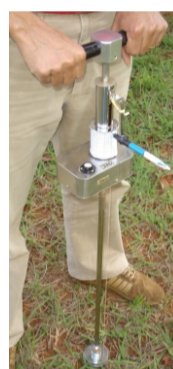
Figura 1. penetrógrafo com haste de 60 cm de comprimento e ponta cônica (padrão ASAE), ligadas a um medidor de força dinâmométrico.
