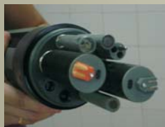
Fig. 2. Sensores da sonda multiparâmetros.
