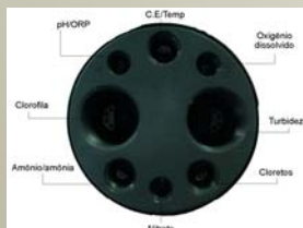
Fig. 2. Sensores da sonda multiparâmetros.
