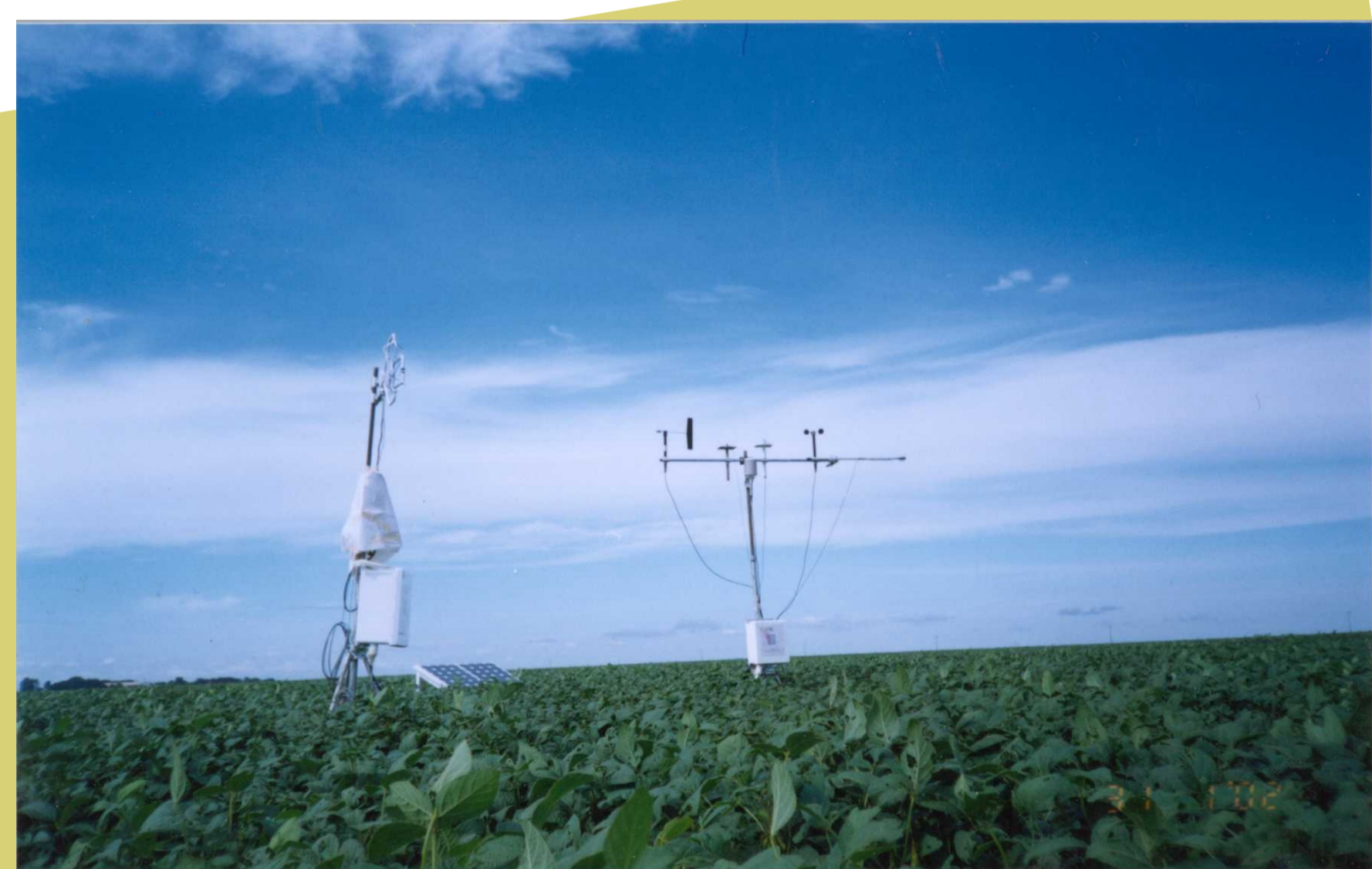
Figura 1. Estação meteorológica automática e sistema de correlação dos turbilhões em um plantio de soja no Núcleo Rural PAD, DF.
