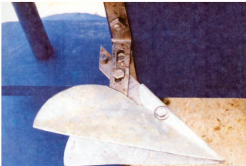
**FIG. 21D.** Vista do sulcador instalado na máquina.
