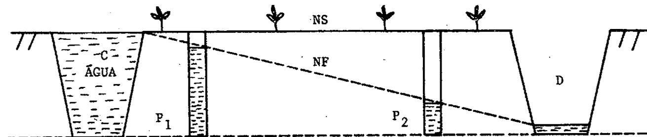
FIG. 1. Esquema de campo ilustrando a metodologia utilizada para obtenção de níveis do lençol freático em solo Gley Húmico. C = Canal mantido cheio de água. D = Dreno. NS = Nível da superfície do solo. NF = Nível do lençol freático. P<sub>1</sub> e P<sub>2</sub> = Poços de Observação.
