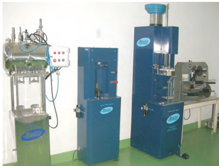
Figura 4. Equipamentos utilizados para o engarrafamento de vinhos, em escala experimental. Da esquerda para a direita: envasadora isobarométrica (para vinhos tranquilos e espumantes); instaladora do arame em garrafas de espumantes; enrolhadora; e rotuladora. Laboratório de Enologia – Embrapa Semi-Árido/Embrapa Uva e Vinho, Petrolina, PE.
