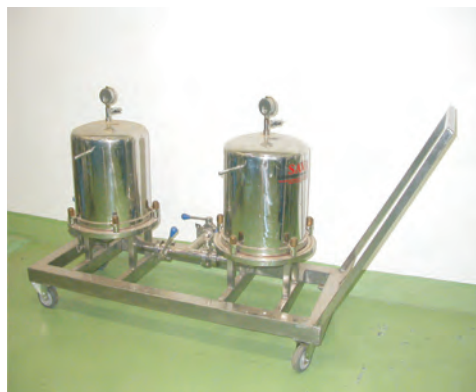
Figura 7. Filtro isobarométrico utilizado para filtração de vinhos tranquilos e espumantes – Laboratório de Enologia – Embrapa Semi-Árido/Uva e Vinho.
