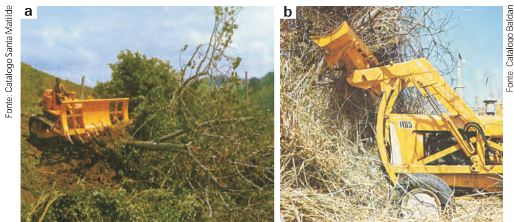
Figura 1. Operações de desmatamento: a) derrubada com trator de esteiras com lâmina cortadora frontal e ancinho; b) amontoa com trator de pneus equipado com lâmina frontal.
