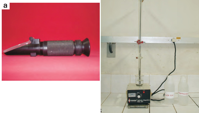
Figura 14. Refratômetro portátil (a), usado para leitura do teor de sólidos solúveis, e material e soluções necessários para a determinação da acidez titulável (b).
