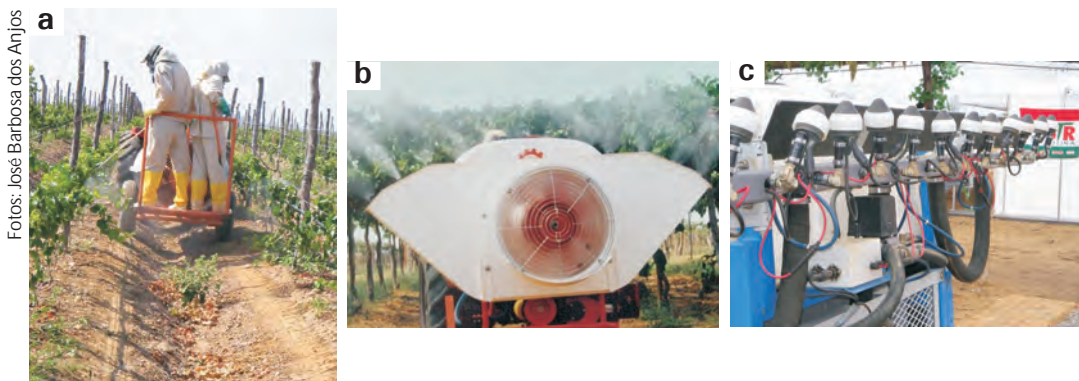
Figura 20. a) bicos pulverizadores com jato dirigido manualmente; b) turbo atomizador; c) pulverizador eletrostático.
