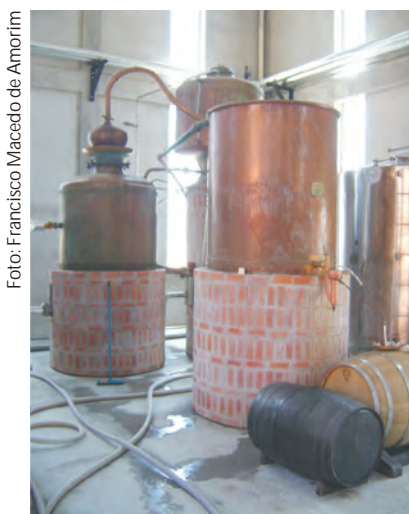
Figura 8. Destilador de cobre para a elaboração de destilados, em uma vinícola do Submédio do Vale do São Francisco, Casa Nova, BA.
