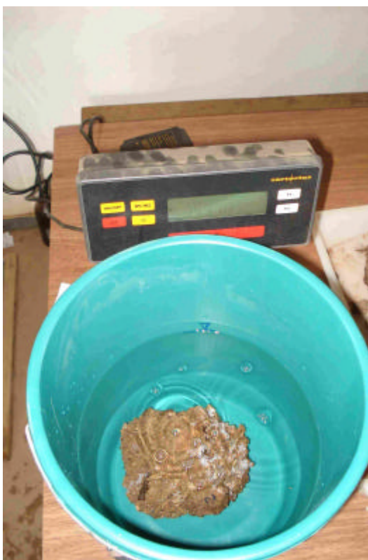
Figura 10. Pesagem do conjunto recipiente + monolito + água em balança analítica.
