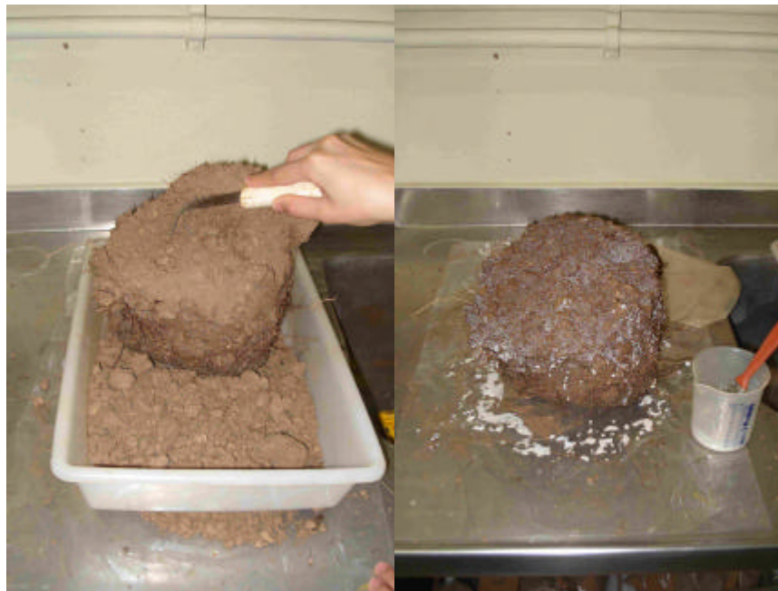
Figura 7. Limpeza e impregnação da base do monolito.
