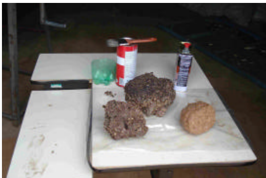
Figura 8. Impregnação da superfície do monolito com a resina acrílica.
