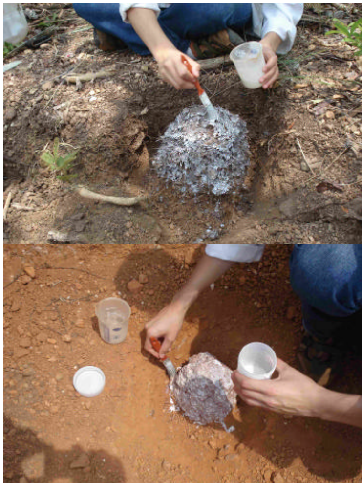
Figura 5. Impregnação da superfície do monólito com a cola de PVA.
