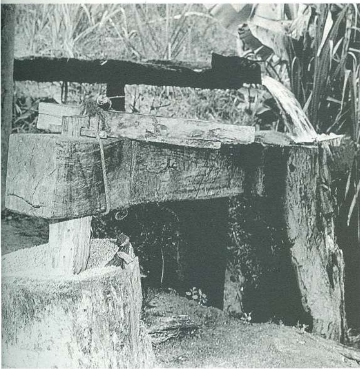
Roda d'água e pilhão - Sistema rústico de processamento de grãos - Fotos: Olímpio P. Oliveira Filho
