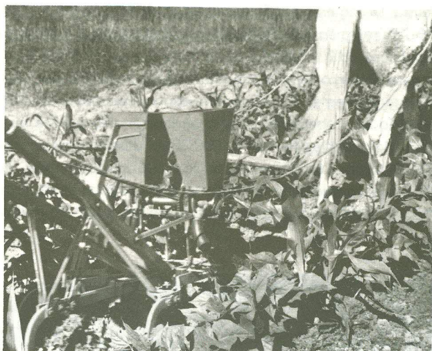
Figura 5. Protótipo desenvolvido pelo CNPMS, que permite a incorporação da adubação nitrogenada.
