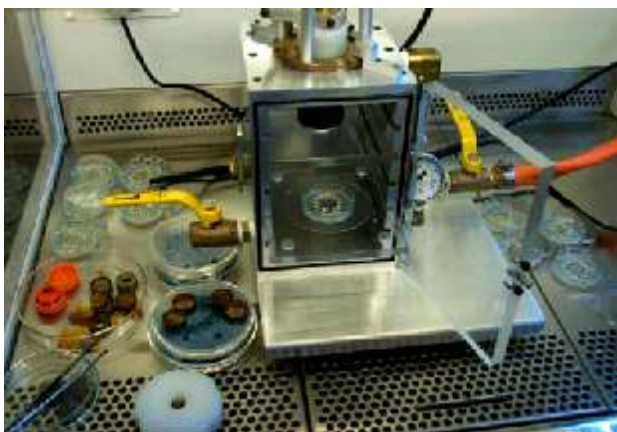
FIGURA 3 - Sistema para transformação em soja pela técnica de biobalística.
