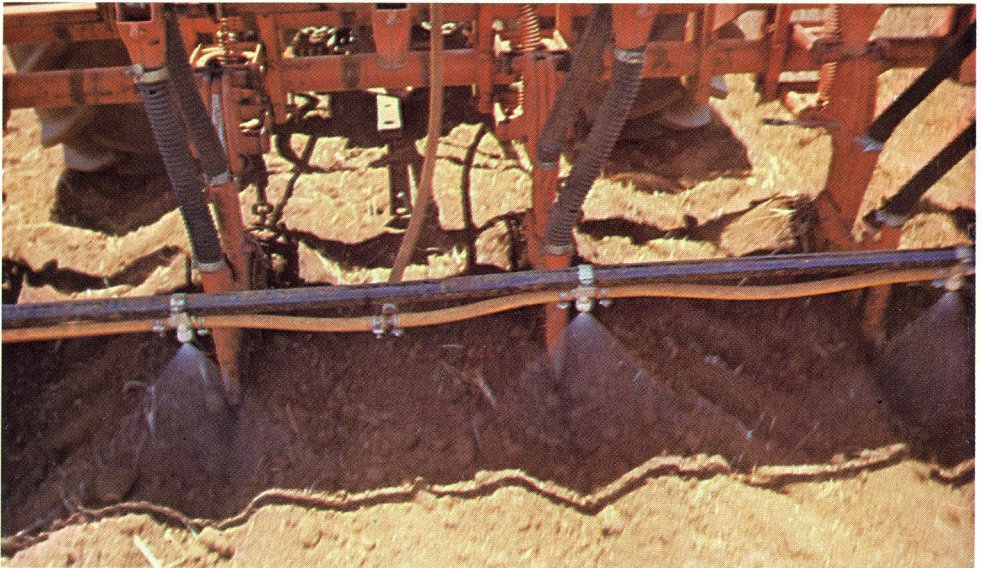
Foto 22. Detalhe do plantio e da aplicação de herbicida em faixa.
