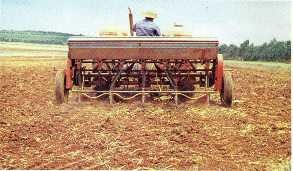
Foto 21. Operação simultânea do plantio e da aplicação de herbicida em faixa.
