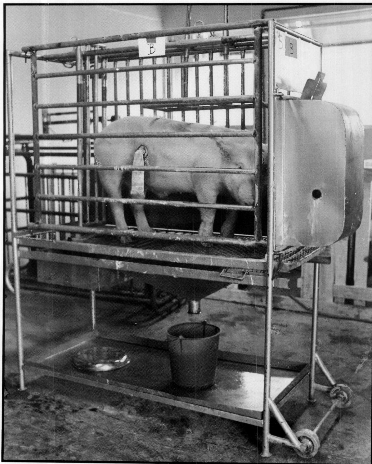
Gaiola de metabolismo utilizada nos ensaios de digestibilidade dos alimentos
