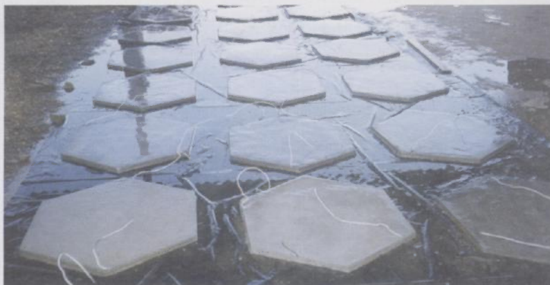
FOTO 1 – Placas de argamassa em processo de cura.
