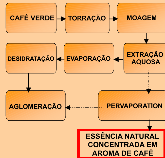
Fig. 1. Diagrama de blocos do processo de obtenção de café solúvel com uma etapa adicional de pervaporação.
