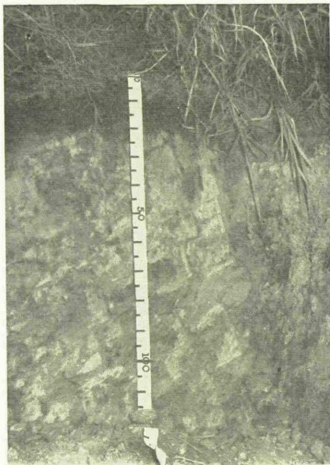
Foto 61 — Perfil de Litosol-fase substrato filito-xisto. Observe-se o horizonte A que se assenta sobre a camada D constituída por filito. Município de Franco da Rocha
