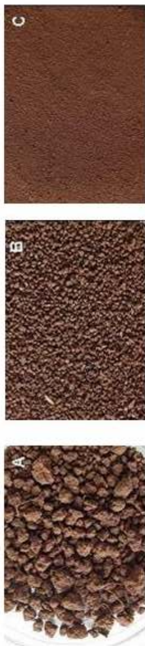
Fig. 4. Fotos de agregados das classes de 4 a 8 mm (A), 1 a 2 mm (B) e 0,125 a 0,053 mm (C). Fonte: Beáta Madari.
