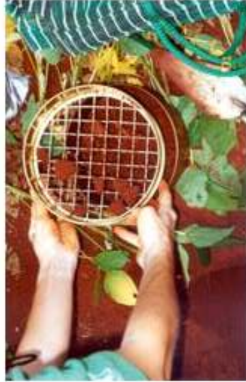
Fig. 2. Procedimento de amostragem de agregados no campo utilizando peneira de 19 mm e permitindo, assim, melhor representatividade da estrutura do solo. Os agregados que passam pela peneira 19 mm são transferidos para laboratório onde se faz o peneiramento úmido para a obtenção das classes de agregados.
