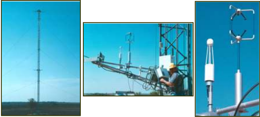
Fig. 6. Torre micro-meteorológica com equipamentos para medição das emissões de CO 2 pelo método da covariância de vórtices turbulentos.
