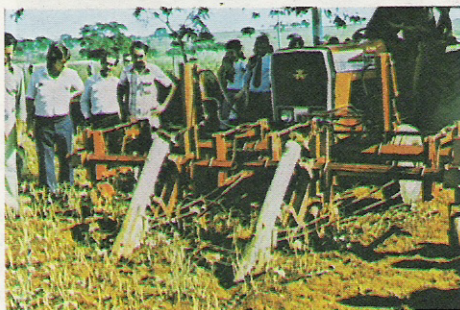
Fig. 14 - Colheita mecanizada de feijão arrancador/cortador
