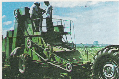
Fig. 15 - Colheita mecanizada de feijão - Recolhedora e Trilhadora CEMAG
