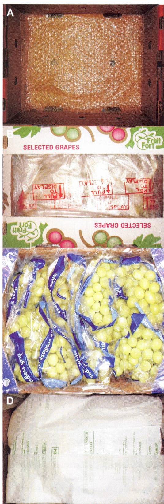
Fig. 13. Materiais que podem compor a embalagem de uvas de mesa: A) plástico polibolha; B) folha de polietileno de baixa densidade (PEBD) perfurada; C) sacos de PEBD para cachos; D) cartela de gerador de \text{SO}_2 envolvida em papel glassine.
