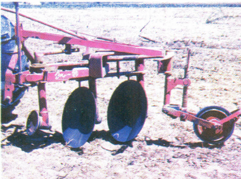
Fig. 1. Arado adaptado, para efetuar o preparo do solo no sistema "Guimarães Duque".
