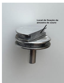
Figura 3. Stub com 13 mm de diâmetro utilizado para fixação dos couros e obtenção das imagens por MEV.
