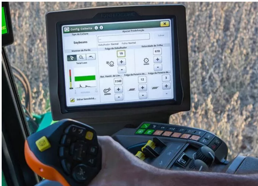
Monitor provê leituras precisas da produtividade e umidade do grão durante a colheita
