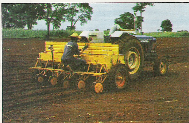
FIG. 3 — Plantio mecânico, com adubação profunda.
