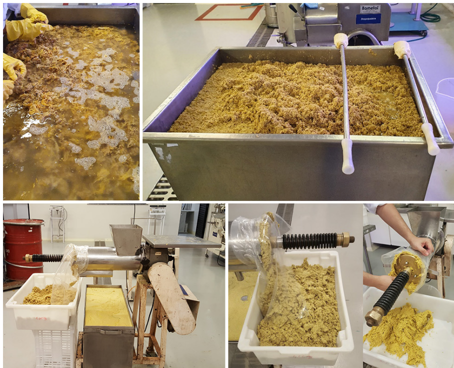
Figura 3. Pré-tratamento da fibra de caju. Ciclos sequenciais de hidratação/lavagem seguidos de prensagem em prensa Expeller .
