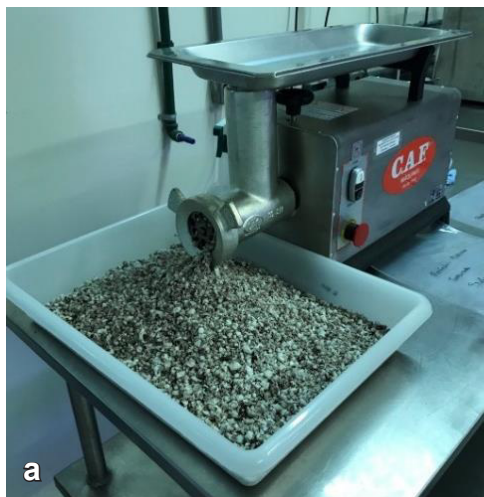
Figura 3. Amêndoas de coco-babaçu trituradas em moedor de carne CAF 8 inox (a); e embaladas em sacos plásticos para armazenamento (b).
