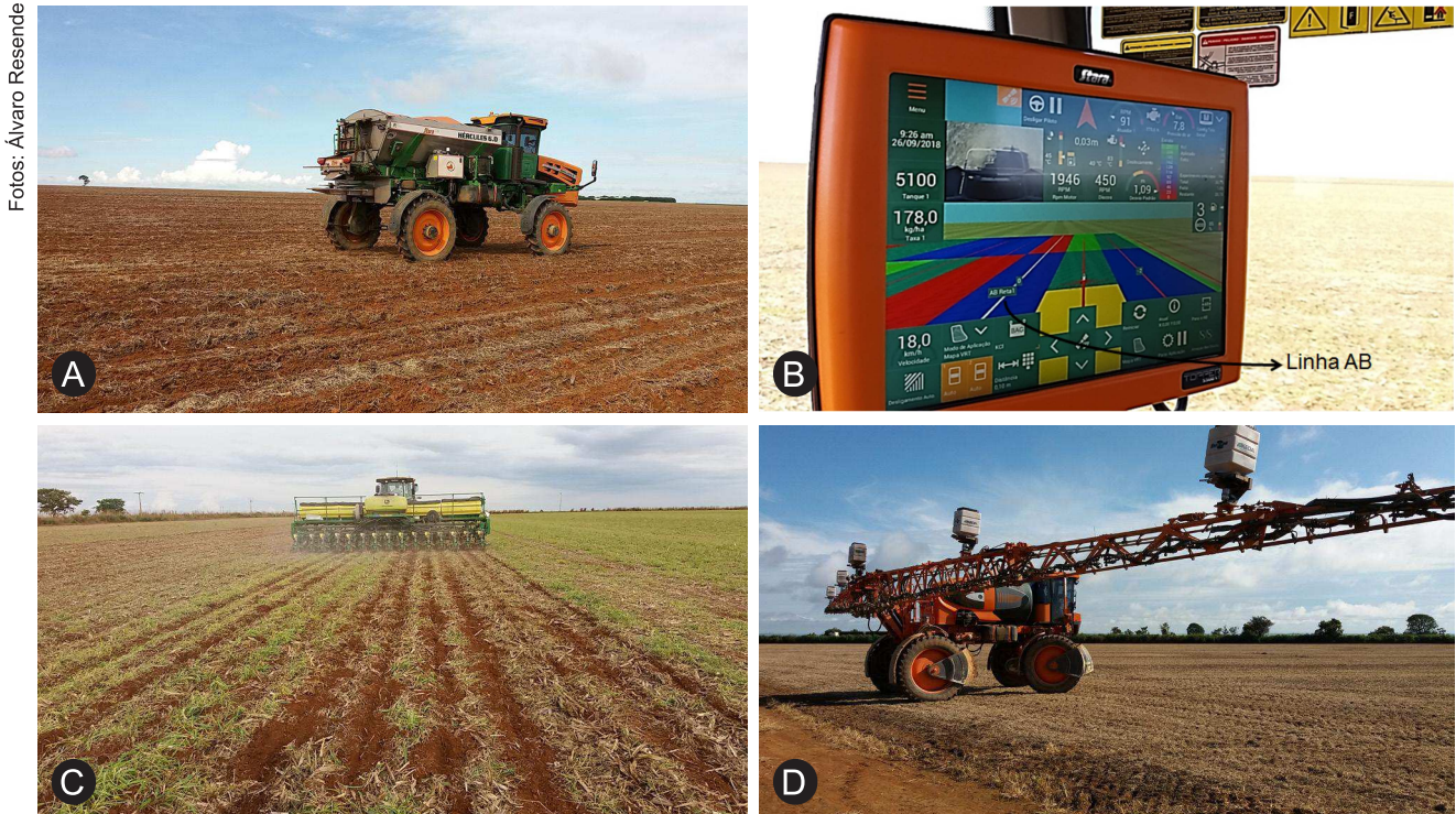
Figura 1. Equipamentos utilizados em experimentação on-farm na Fazenda Decisão, Unaí, MG. A) autopropelido de distribuição a lanço de fertilizantes, regulado para aplicação em faixas de 30m, correspondendo à largura das parcelas; B) tela do monitor do sistema de distribuição de fertilizantes a taxa variável, na qual podem ser visualizadas as parcelas experimentais em retângulos de cores diferentes (doses de adubo) e a “Linha AB” demarcando o alinhamento a ser seguido no campo; C) semeadora de 15 linhas dotada de sistema de distribuição de fertilizante a taxa variável no sulco, com 7,5m de largura; e D) pulverizador autopropelido com dispositivos de distribuição de sementes de braquiária acoplados à barra de pulverização, regulado para aplicações em faixas de 30 metros de largura.
