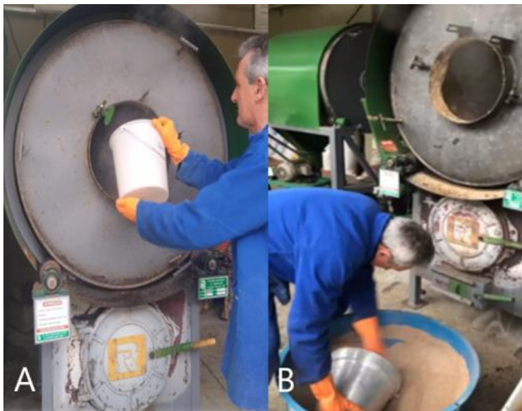
Figura 4. Adição do ingrediente (farelo de trigo ou soja) para absorção da fração do óleo à massa do coproduto durante a etapa de desidratação.
