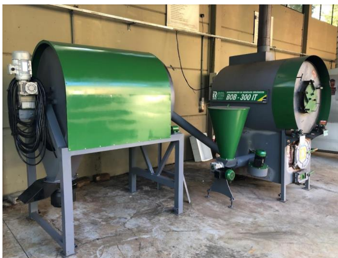
Figura 5. Sistema de resfriamento do equipamento para produção do DPP.
