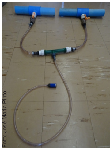
Figura 4. Esquema de montagem de um injetor de fertilizante tipo Venturi.
