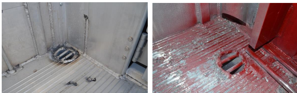
Figura 17. Pisos com disposição de coletores de dejetos para evitar o espalhamento durante a viagem.
