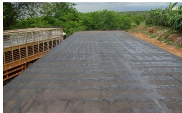
Figura 3. Carrocerias com sistema de proteção contra o sol (sombrite) que bloqueia parte da radiação protegendo os suínos.
