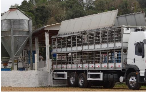
Figura 11. Carrocerias metálicas com piso borboleta (abertura total e parcial) que facilita o manejo para conduzir os suínos.
