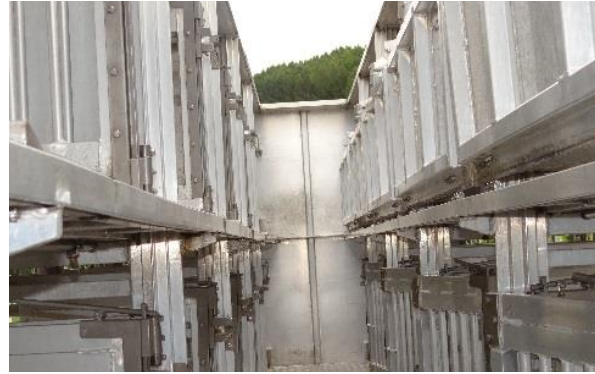
Figura 11. Carrocerias metálicas com piso borboleta (abertura total e parcial) que facilita o manejo para conduzir os suínos.
