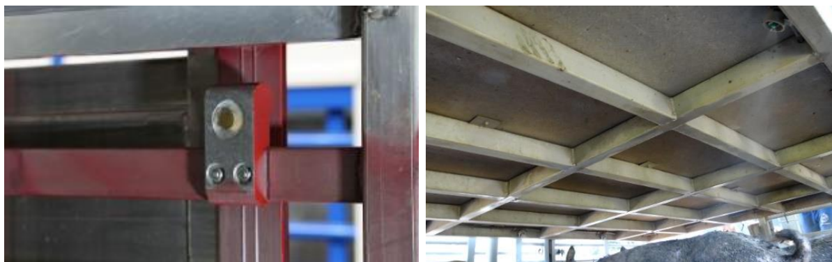
Figura 26. Sistema de nebulização com água nos compartimentos de carga.
