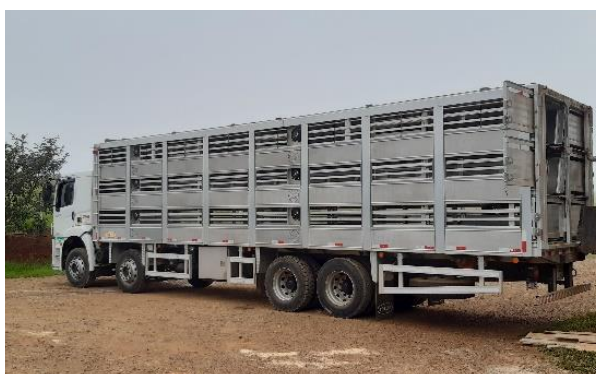
Figura 4. Veículo com carroceria com painéis deslizantes de alumínio que regulam a abertura das janelas laterais, e na parte superior com proteção rígida (teto) e isolamento térmico.
