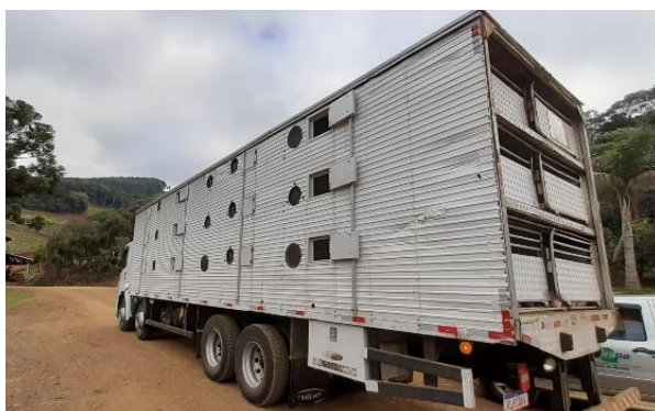
Figura 25. Sistema de ventilação mecanizada nos compartimentos de carga. Ventiladores são instalados em diversos pontos das laterais do veículo, para assegurar a ventilação adequada.
