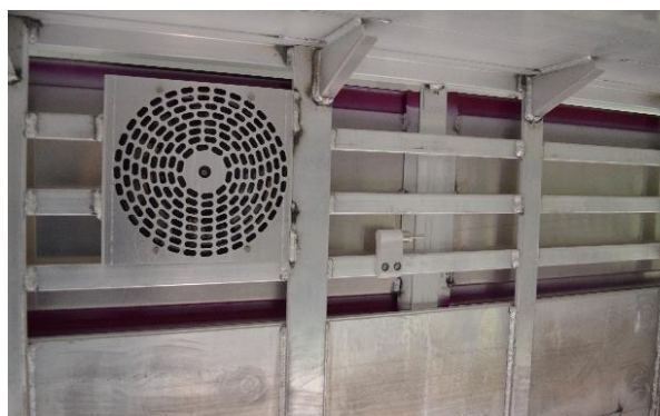
Figura 25. Sistema de ventilação mecanizada nos compartimentos de carga. Ventiladores são instalados em diversos pontos das laterais do veículo, para assegurar a ventilação adequada.
