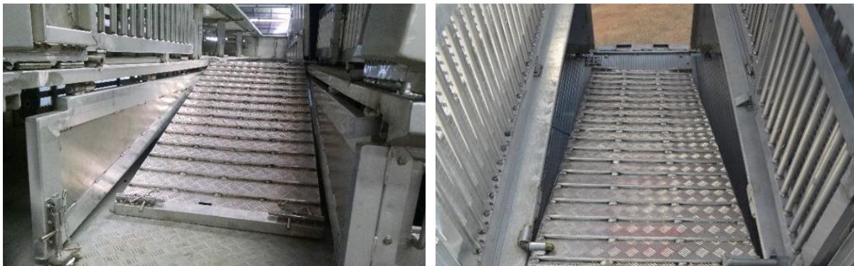
Figura 19. Rampa interna do veículo com piso antiderrapante e laterais fechadas e resistentes, reduzindo os riscos de escorregões/queda, evitando paradas e distrações.
