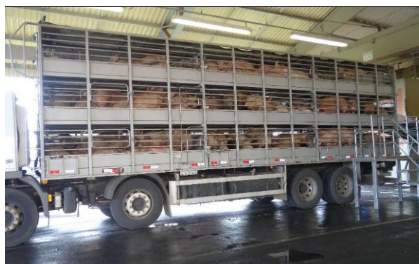
Figura 8. metálica de três pisos fixos.
