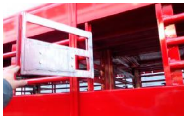
Figura 23. Abertura lateral projetada no compartimento de carga para facilitar a inspeção visual dos animais durante a viagem, ou evacuação durante acidentes.
