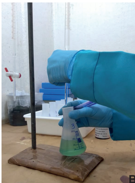
Figura 8. Inserção de reagente (A) e titulação da amostra de água (B).
