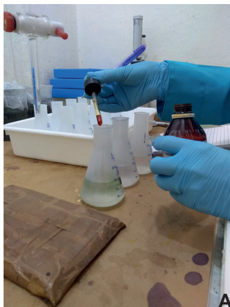
Figura 8. Inserção de reagente (A) e titulação da amostra de água (B).
