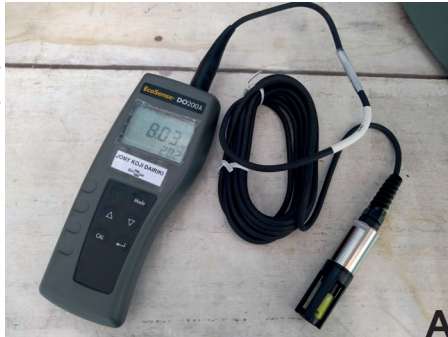
Figura 5. Oxímetro digital (A) e uso do equipamento no viveiro experimental (B).
