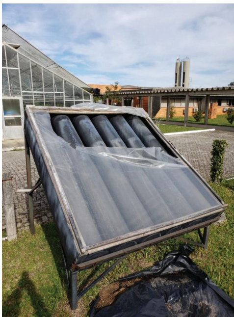
Figura 11. Foto do solarizador, utilizado para desinfestar o substrato em que serão plantadas as sementes, quando do início de sua germinação.
