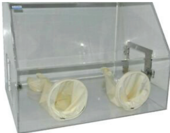
Figura 13. Conhecida como capela de luvas, apesar de diferente do modelo existente na antiga Estação Experimental, dá uma ideia de como sua utilização era mais difícil, em comparação com as atuais.
