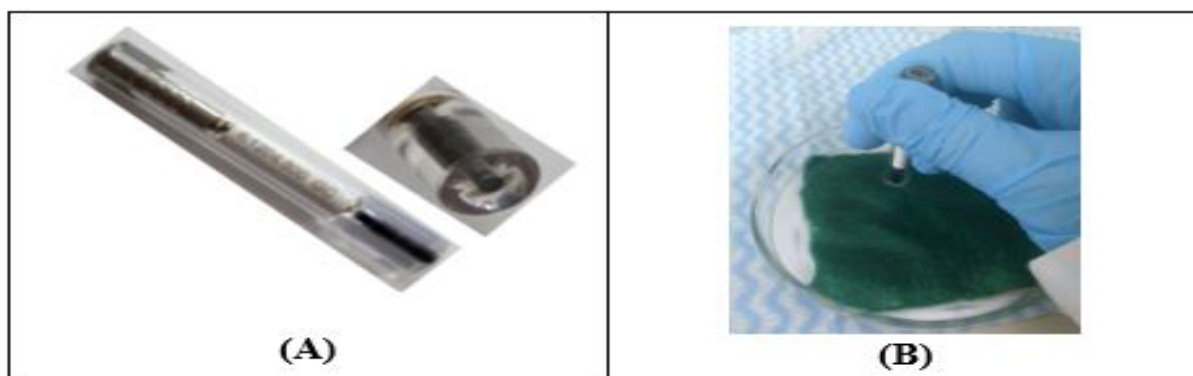
Figura 2: Eletrodo comercial de carbono vítreo utilizado como eletrodo de trabalho nas análises voltamétricas (A) e o processo de limpeza mecânica de sua superfície (B). Fotos de Gabriella Magarelli e Caroline Matos Ribeiro
