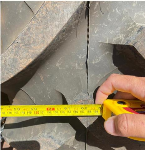
**Figura 5.** Aferição da bitola do trator, adotando como ponto de leitura o centro do rodado traseiro do pneu.
