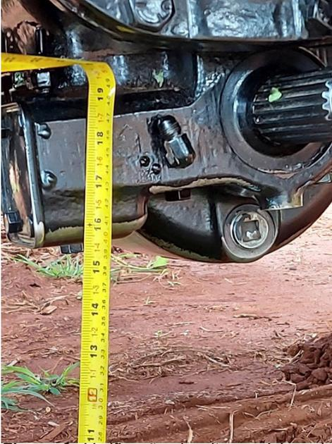
**Figura 8.** Verificação da altura mínima do vão livre vertical (distância medida entre o solo e o ponto mais baixo na parte inferior do trator) que, neste modelo de trator, encontrava-se no limite mínimo.
