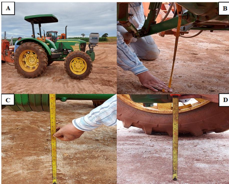
**Figura 7.** Trator com altura uniforme durante todo seu comprimento (A). Aferição da altura na barra de três pontos (B), no lastro dianteiro (C) e no eixo de transmissão da tração dianteira (D) para verificação da adequação do trator ao Antecipe.
