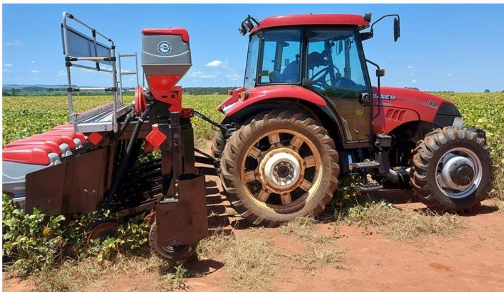
Figura 3. Detalhe do trator com tração dianteira durante operação de semeadura do Antecipe.
