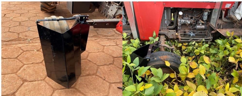
**Foto 16.** Protótipo de protetor dianteiro fabricado para testes na semeadura do milho Antecipe em cultivar de soja que apresentou alto potencial de engalhamento (A) e durante a operação de semeadura do milho no Antecipe, deslocando as plantas para a lateral (B). Rio Verde-GO, 2021.
