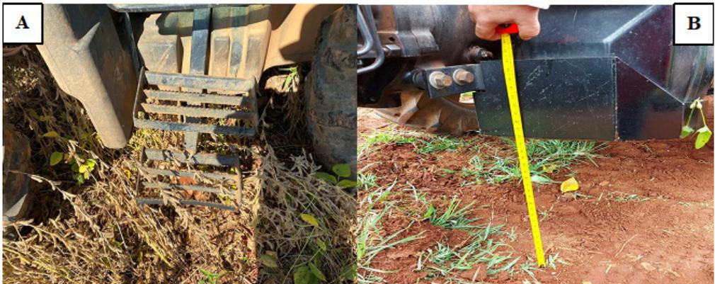
**Figura 9.** Outros pontos de verificação no trator: presença de escada lateral (A) e tanque de combustível com protetor (B).
