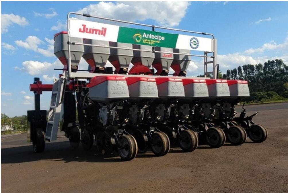
**Figura 2.** Semeadora-adubadora desenvolvida pela Jumil para implantação do sistema Antecipe.
