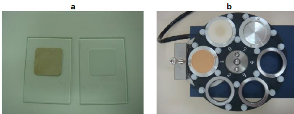
Figura 5. Recipientes para montagem não orientada (amostras em pó): (a) lâminas de vidro com cavidade rasa e (b) recipientes de alumínio em porta-amostras. Fotos: Gilson Gregoris.
