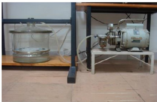
Figura 7. Sistema para solvatação com etilenoglicol a frio, composto por um dessecador e uma bomba de vácuo. Fotos: Gilson Gregoris.
