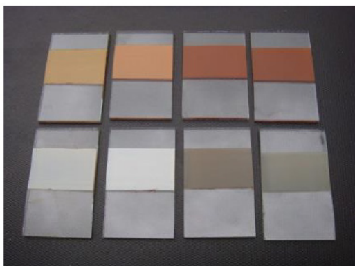
Figura 6. Alteração da cor de amostras de argila após a desferrificação: amostras não tratadas (superiores) e desferrificadas (inferiores). Foto: Gilson Gregoris.
