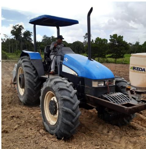
**Figura 8.** Semeadeira utilizada para o plantio da braquiária acoplada na parte frontal do trator.
