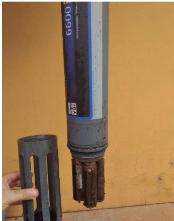
Figura 36. Sonda sem o copo de proteção retirado para limpeza.
