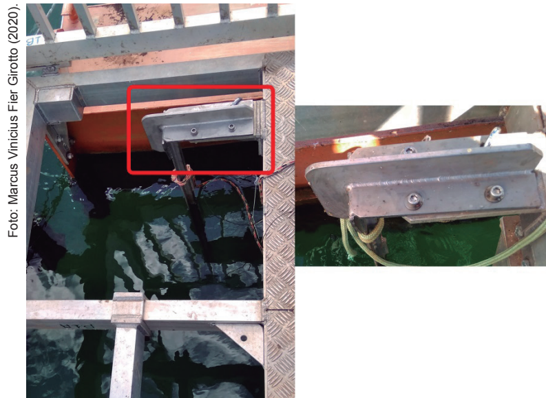
Figura 38. Haste da sonda fixada no suporte do Sima.
