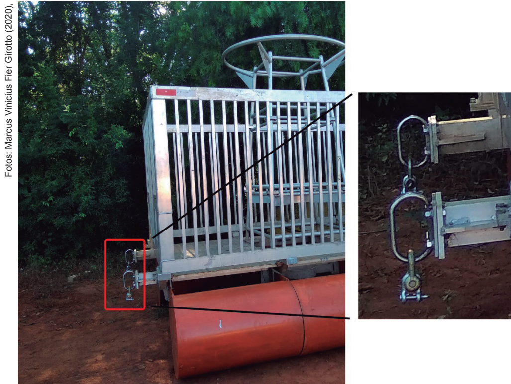
Figura 24. Sistema de Monitoramento Ambiental Integrado já montado e com destaque para o ponto de fixação dos cabos das poitas.
