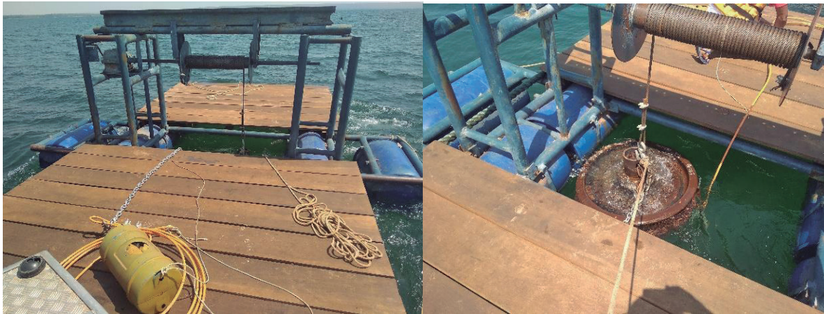
Figura 12. Lançador de poita sendo levado para o ponto em que a plataforma será posicionada.
