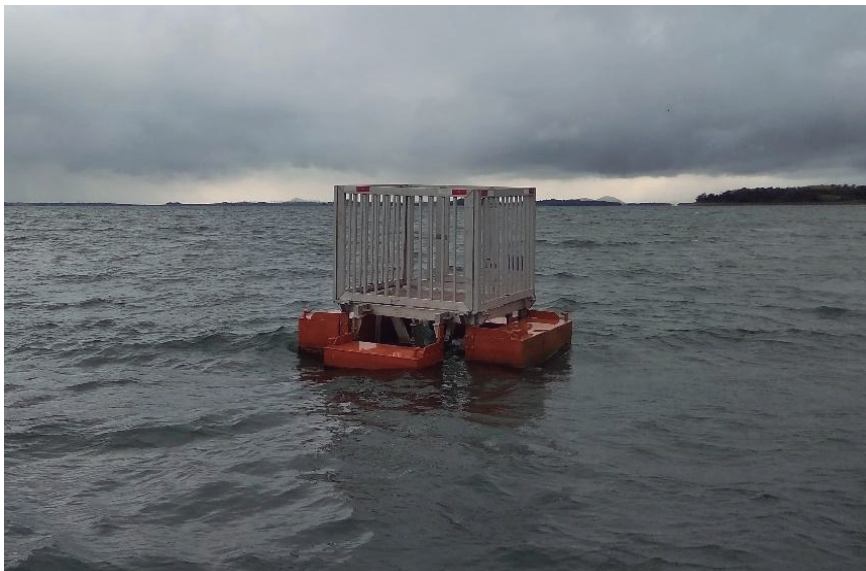
Figura 4. Plataforma de Coleta de Dados instalada dentro da área aquícola, mas para coleta de dados de influência indireta do cultivo.
