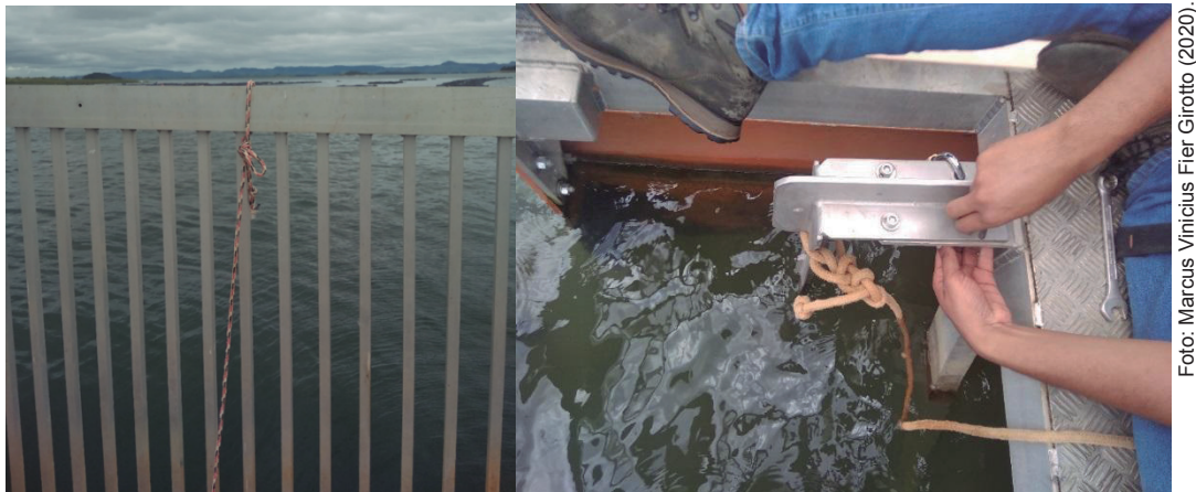
Figura 27. Corda para garantir a segurança e a fixação da haste da sonda na Plataforma.
