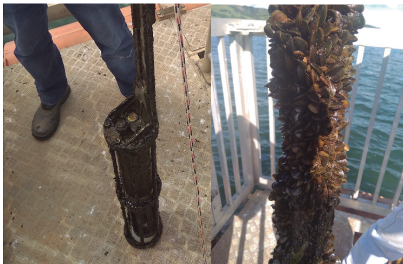
Figura 35. Sonda e sua haste com limo (esquerda) e mexilhão dourado (direita).
