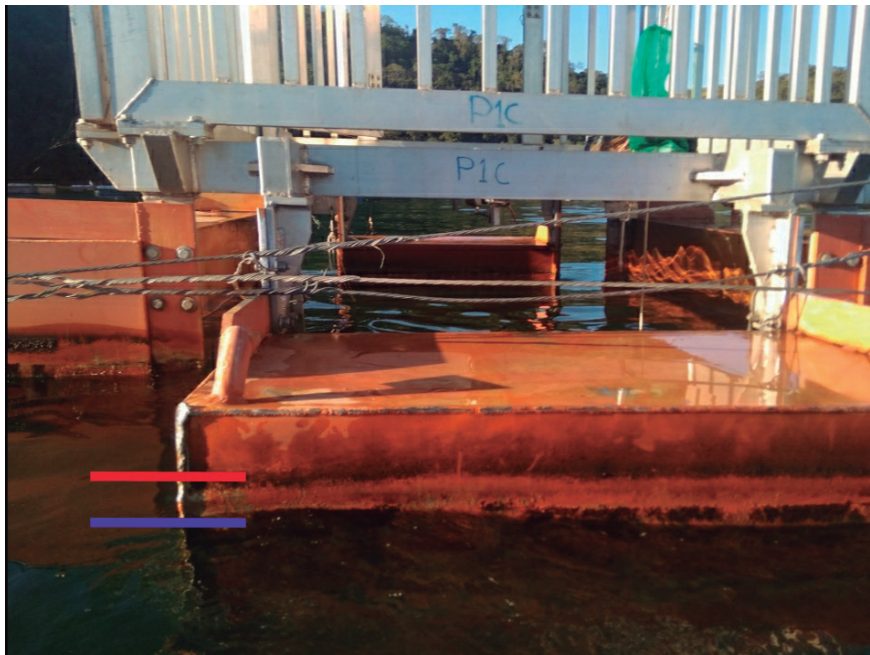
Figura 31. A linha vermelha marca o ponto necessário para verificação do flutuador da PCD (menos de 10 cm). A linha azul marca o ponto normal do flutuador.
