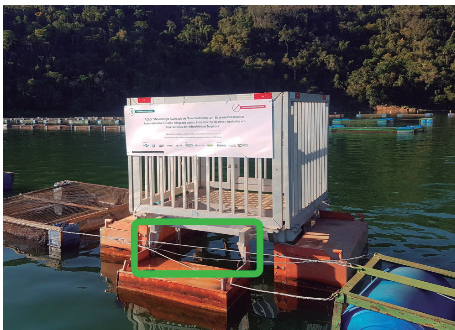
Figura 8. Plataforma de Coleta de Dados instalada na linha de tanques-rede e fixada no cabo de aço da própria linha.
