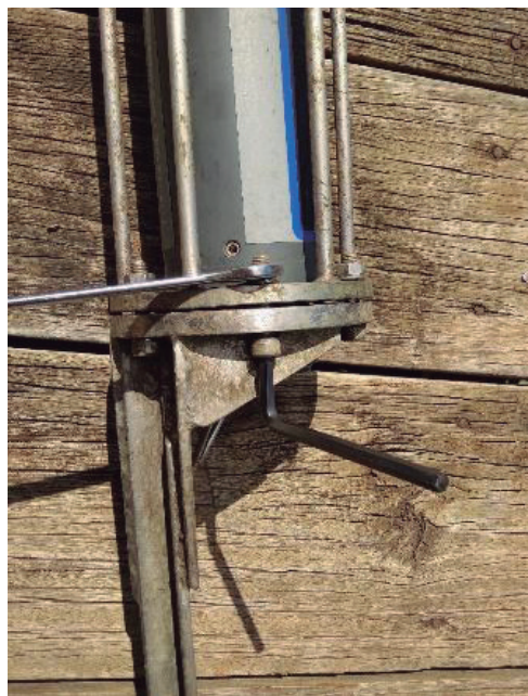
Figura 25. Sonda sendo fixada na sua estrutura de proteção.
