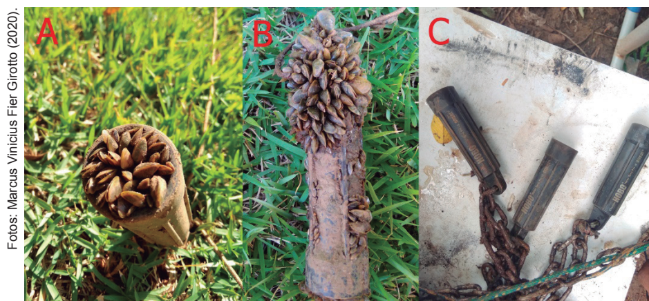
Figura 39. Sensores de temperatura sujos com incrustações de mexilhão dourado (A e B) e após a limpeza (C).
