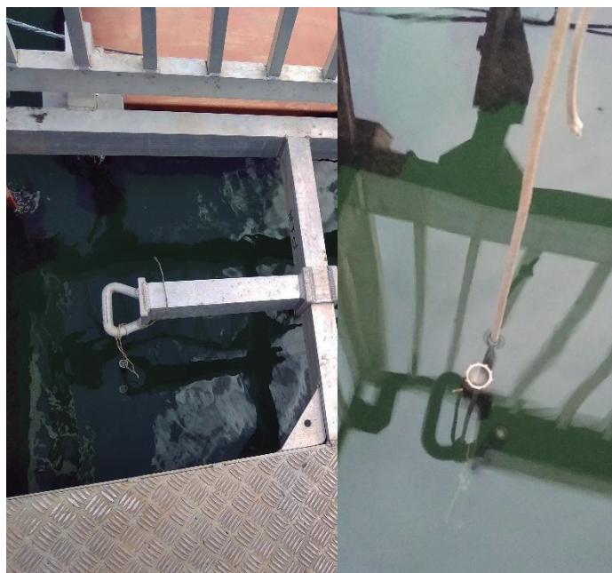
Figura 30. Linha de sensores para monitoramento da temperatura ao longo da coluna da água. Detalhe para o local de amarração da linha e sensor bem próximo da superfície.
