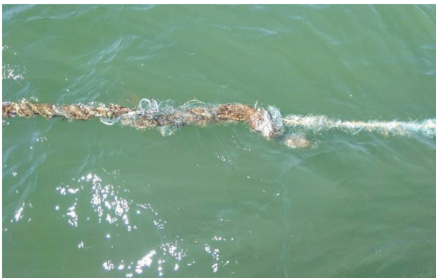
Figura 5. Corda principal de uma linha de tanques-rede desgastada devido ao atrito com a plataforma.
