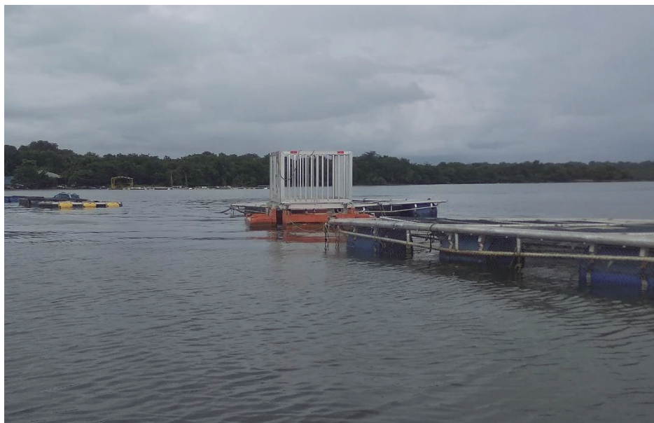
Figura 7. Plataforma de Coleta de Dados instalada na linha de tanques-rede, fundeada próxima aos tanques-rede.
