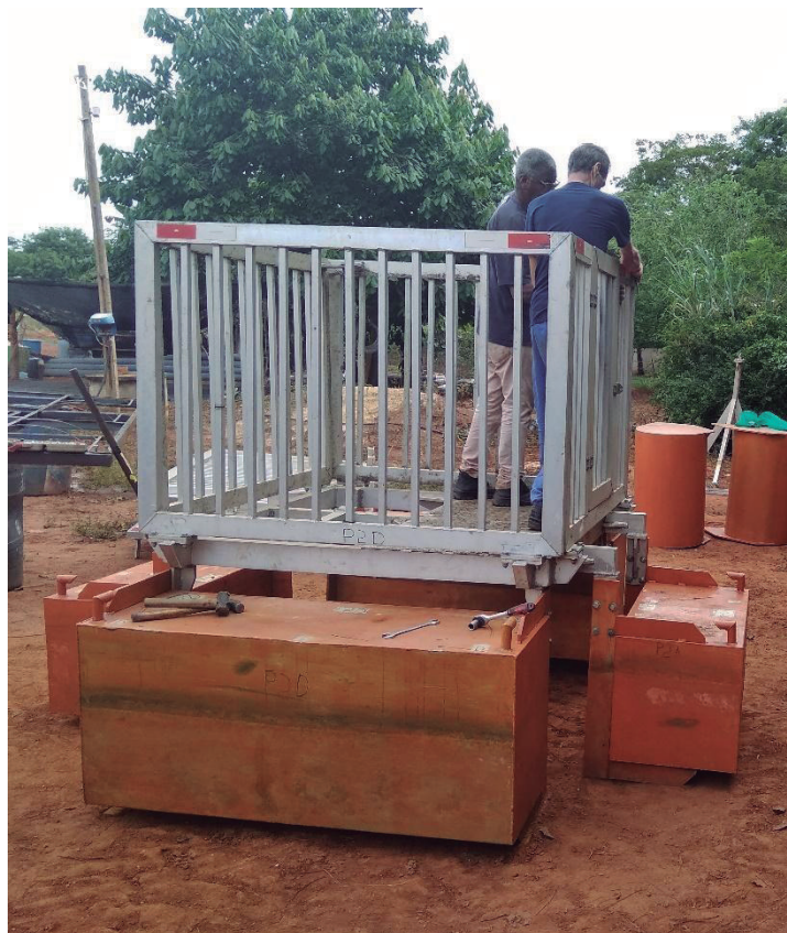
Figura 20. Fixação das laterais da Plataforma de Coleta de Dados.
