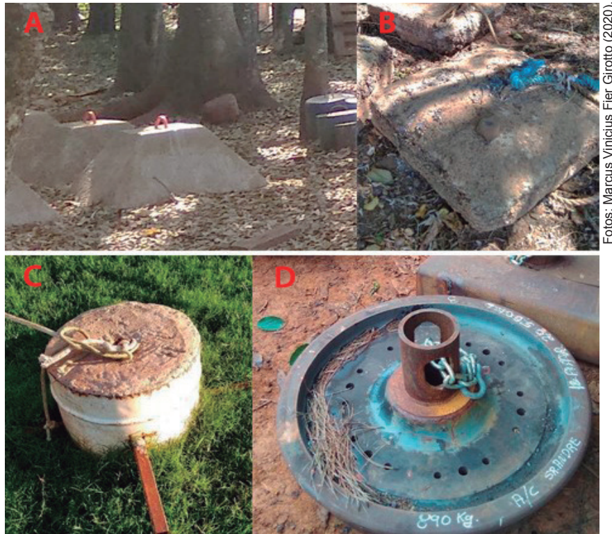
Figura 11. Modelos de poitas comumente empregados: trapezoidal (A), paralelepípedo (B), cilíndrica (C) e roda de trem (D).
