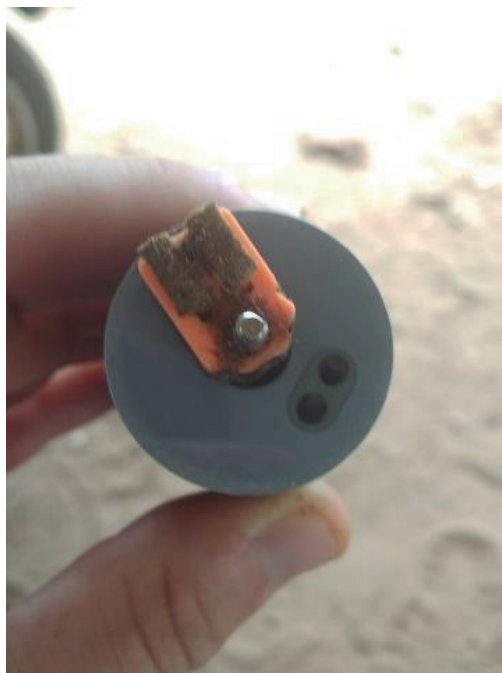
Figura 37. Sensor limpo, mas com a esponja necessitando de limpeza ou substituição.
