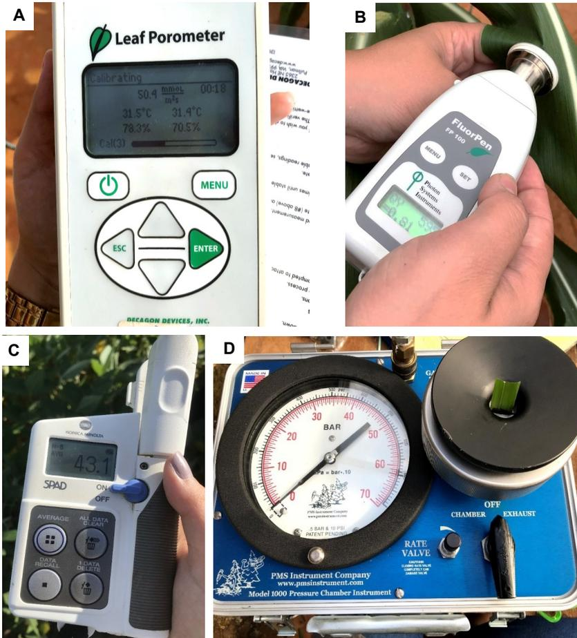
**Figura 3.** Avaliações ecofisiológicas da condutância estomática na folha, rendimento quântico máximo do PSII, teor relativo de clorofila e potencial hídrico foliar, por meio dos instrumentos, respectivamente: Porômetro (A); FluorPen FP 100 (B); SPAD (C); Bomba de Scholander (D).
