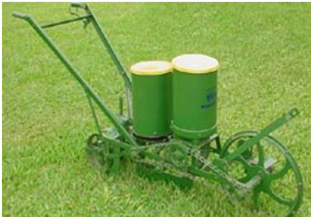
Plantadora y esparcidor de fertilizante
