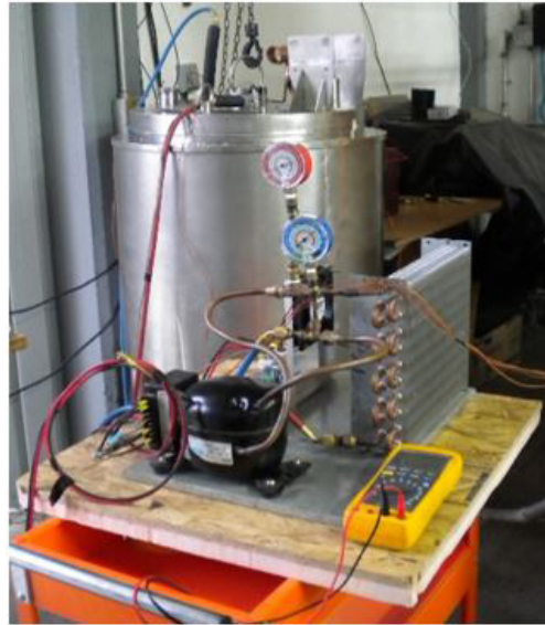
Figura 5 Compresor Danfoss BD35F conectado a la olla lechera
