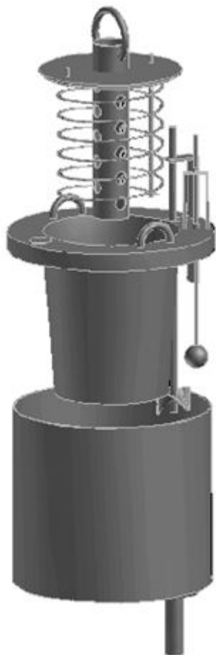
Figura 4 Acoplamiento del tanque externo-interno y la tapa del tanque interno que contiene el serpentín de cobre
