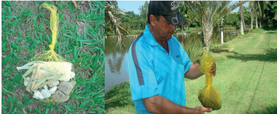
Figura 3. Coletor com substrato artificial composto de folhas de taboa, pedras, bucha vegetal e brita, envoltos por saco de fruta de 5 kg.
