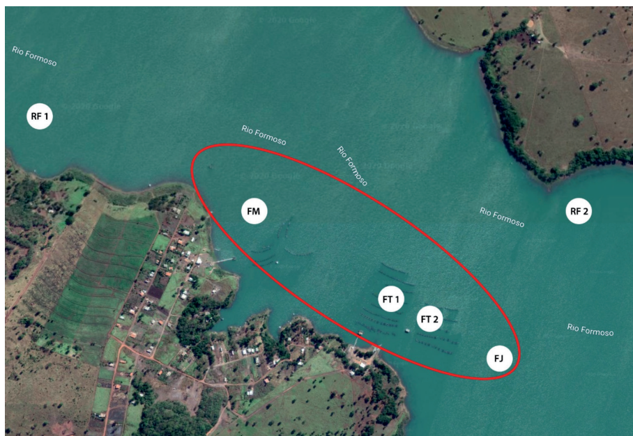
Figura 1. Ilustração dos pontos de coleta, tendo o reservatório de Ilha Solteira – Rio Formoso como exemplo. Destaque para a área de produção (linhas de tanques-rede dentro do círculo vermelho). RF 1 – Rio Formoso 1; FM – Formoso montante; FT 1 – Formoso tanque 1; FT 2 – Formoso tanque 2; FJ – Formoso jusante; RF 2 – Rio Formoso
