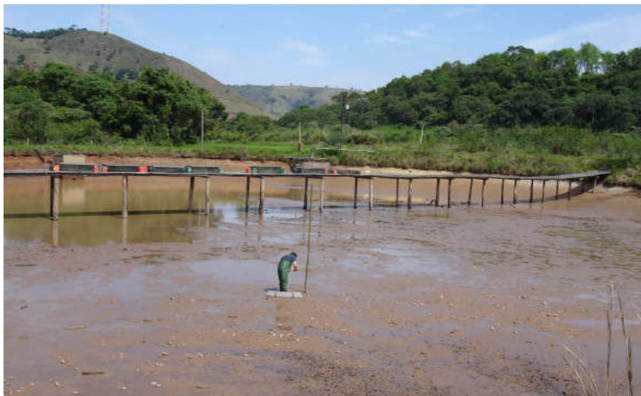
Figura 3. Coleta de amostras de sedimentos do fundo do reservatório da APTA em Monte Alegre do Sul para determinar a necessidade de calagem.
