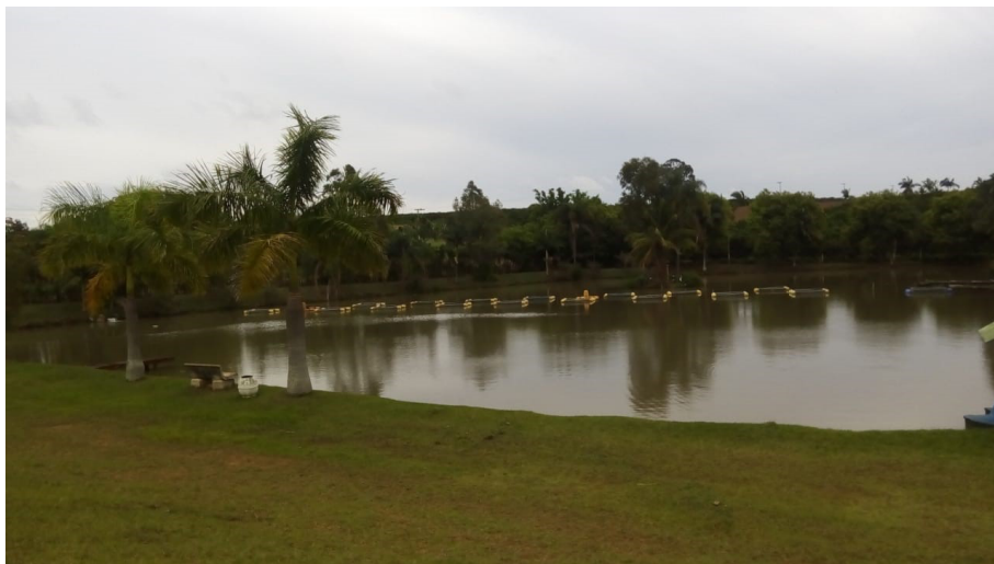
Figura 1. Vista geral de um reservatório rural em área com preservação adequada da cobertura vegetal, e com vários tanques-rede instalados de forma correta com distanciamento mínimo entre as linhas de 5 metros para permitir uma boa circulação da água entre eles.
