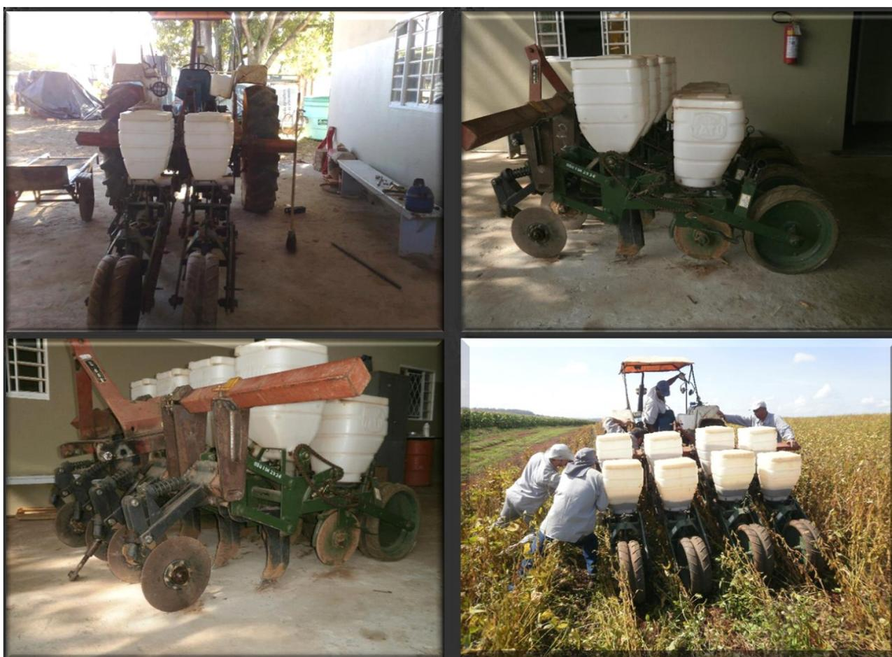
**Figura 8.** Protótipo de semeadora-adubadora desenvolvido pela equipe da Embrapa Milho e Sorgo (Sete Lagoas-MG) para semeadura mecanizada do milho nas entrelinhas da soja (depósito de patente BR 10 2020 009566 8).
