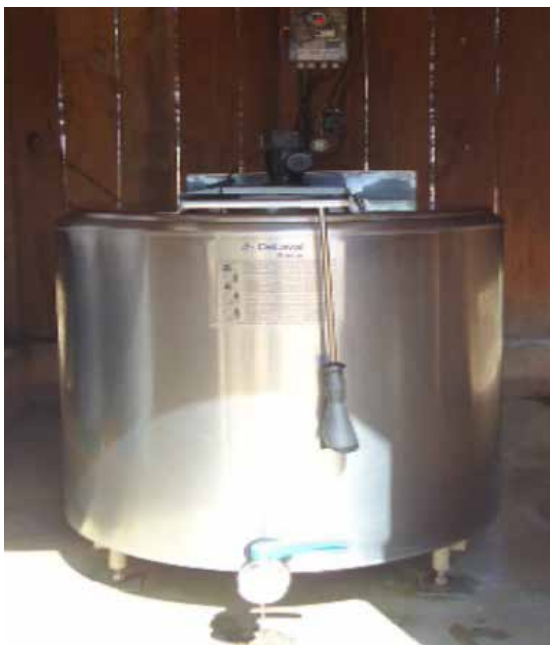
Figura 7. Tanque de resfriamento de uso comunitário.
