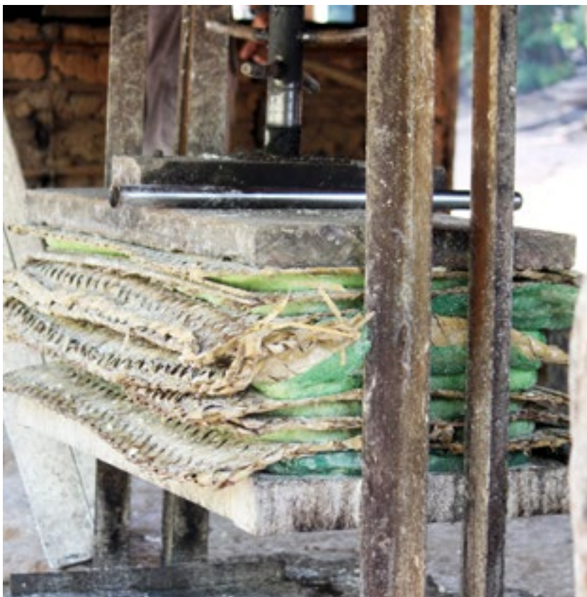
Prensagem de massa de mandioca utilizando esteiras de palha de babaçu e folhas de bananeira.
