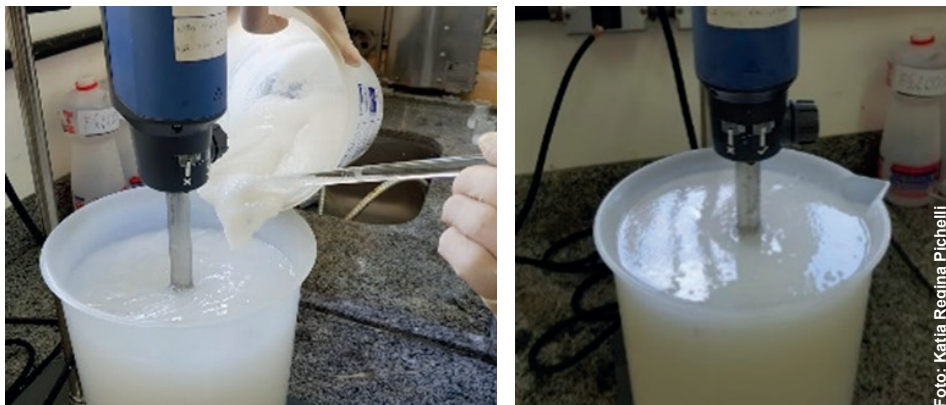
Figura 4. Adição de gel de celulose com TEA em álcool hidratado contendo ácido esteárico, sob forte agitação, até completa homogeneização (entre 5 e 10 minutos).
