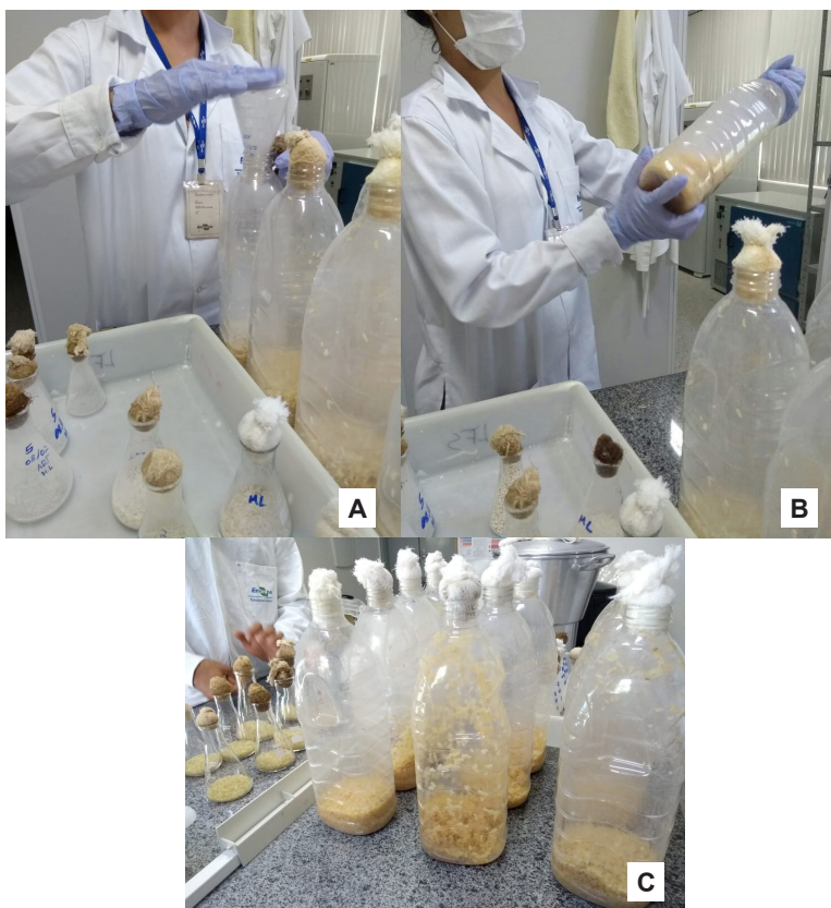
Figura 4. Fases da produção de Bauveria bassiana em condições ambiente: inoculação do meio de cultura (A); homogeneização do fungo no substrato (B); e fechamento das garrafas com tampões de algodão (C). Aracaju, 2018.
